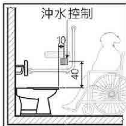
圖4-12 沖水控制設置立面
