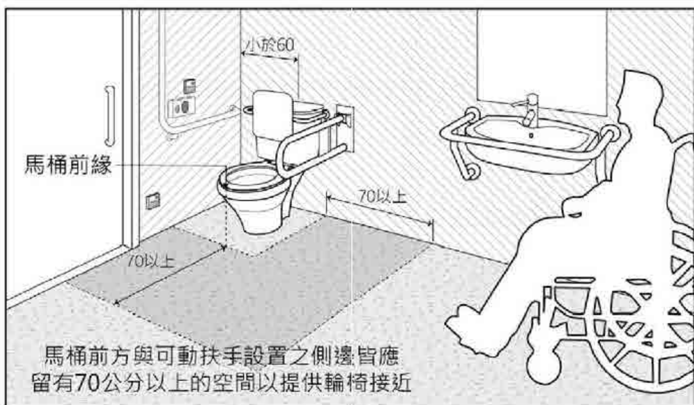
圖4-14 無障礙廁所馬桶與扶手設置示意
