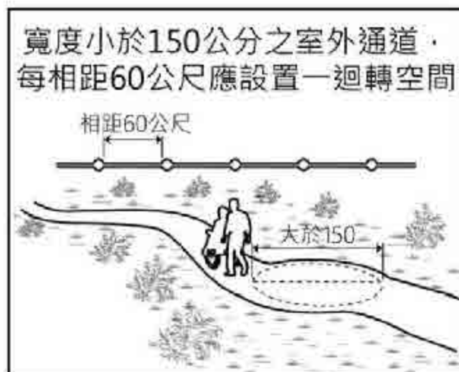
圖2-19 室外輪椅迴轉空間設置
